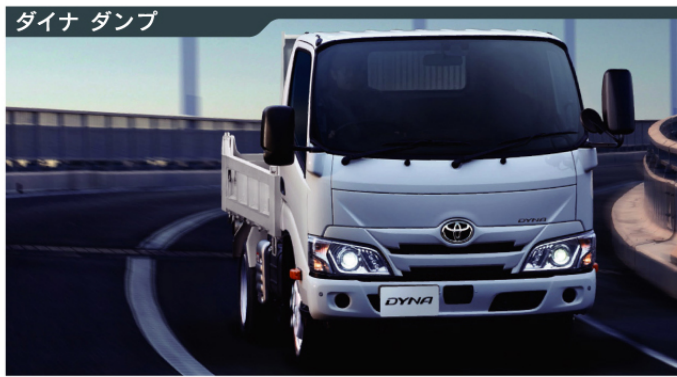
Photo:ダイナ ダンプ<10尺テック・高床・3.0トン積・2WD・6MT>
